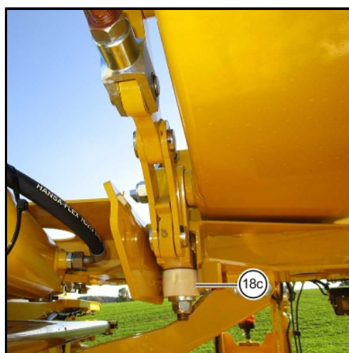
(18c) Verriegelung Gegengewichtsarm geschlossen
