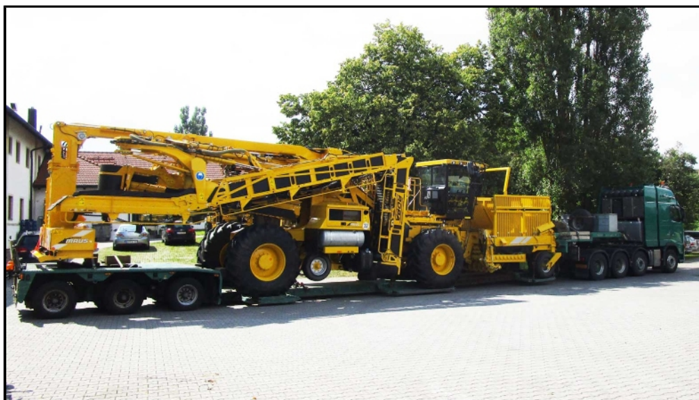
Ordentlicher Tieflader für Straßenstransport mit Minimaltransporthöhe
