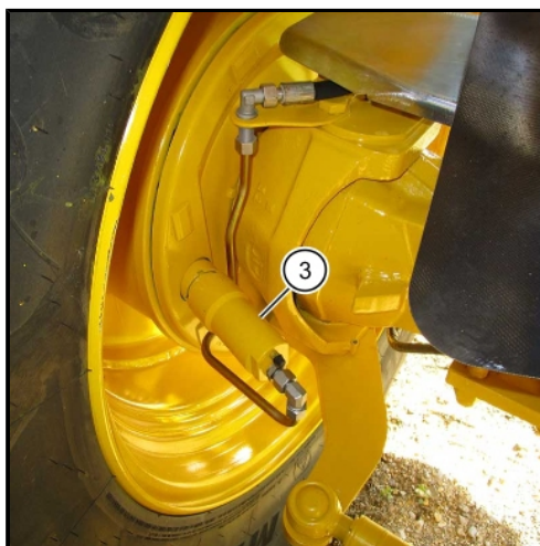
(3) Hinterachse mit hydraulisch betätigter Trommelbremse
