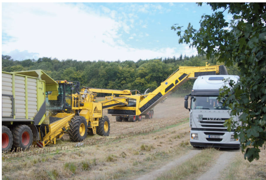
Bei der NawaRo-Bunkermaus wird das Häckselgut direkt in einen Bunker gekippt. Eine Verunreinigung ist somit ausgeschlossen.
