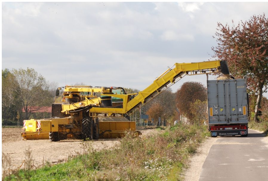
Der flexible Überladearm kann bis zu 13 m überladen und problemlos Gräben, Feldraine oder Hecken überbrücken.
