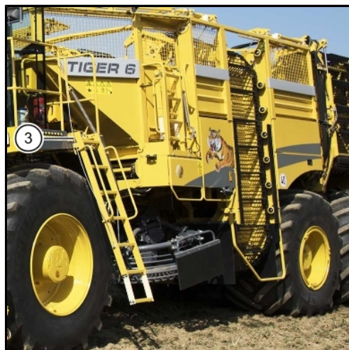
Aufstieg Fahrerkabine in Stellung Straßenfahrt bzw. Rodebetrieb
