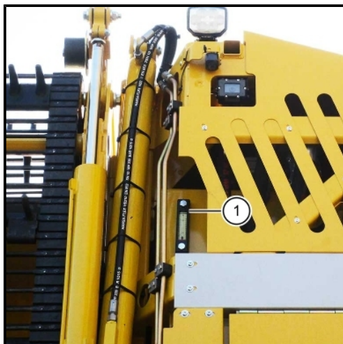
(1) Schauglas Ölstand + Öltemperatur
