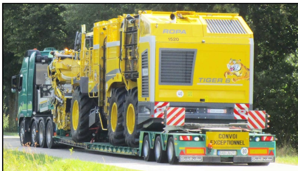
Ordentlicher Tieflader für Straßentransport mit Minimaltransporthöhe
