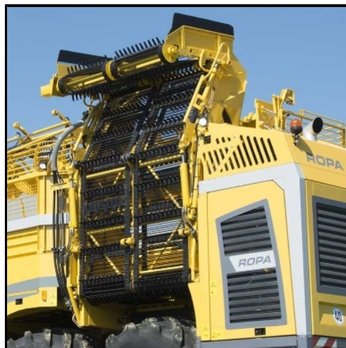
Entladebandknickteil 1 und 2 in Rodestellung
