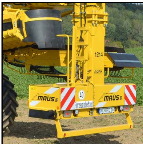
Hilfstreppe am Kraftstofftank in Straßenstellung bzw. abgeklappt zum Betanken
