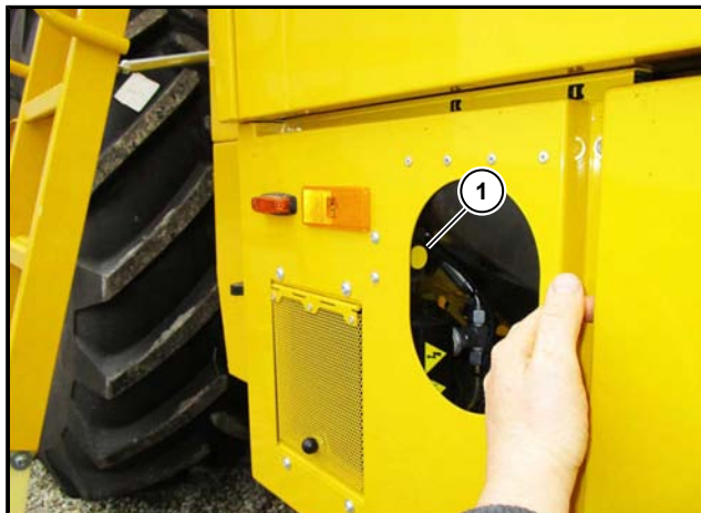
(1) Taster für die Aufstiegsbeleuchtung aussen an der Maschine
