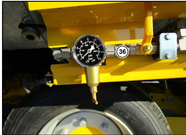
(36) Druckminderer für die Wassersprühanlage
