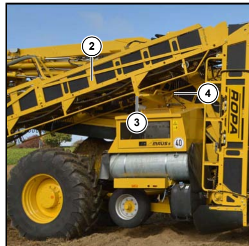
Überlader korrekt auf der Transportstütze abgelegt.
