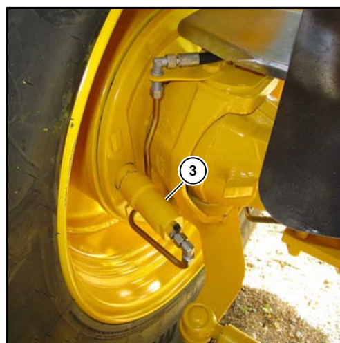
(3) Hinterachse mit hydraulisch betätigter Trommelbremse
