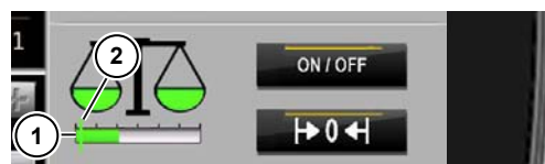
Summierschwelle überschritten, Waage addiert Gewicht auf
