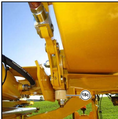
(18c) Verriegelung Gegengewichtsarm geschlossen
