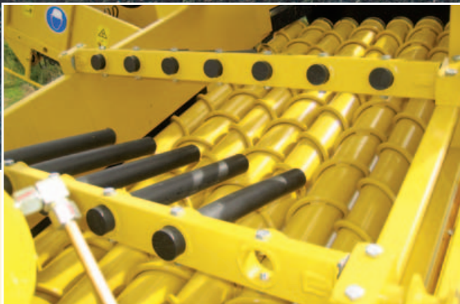
Zwickwalzenreiniger mit einstellbarer Rübenbremse
