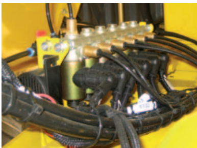
Getriebe – Elektro- pneumatische Gangschaltung
