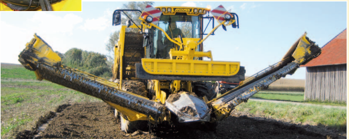
Umstellung für die Straßenfahrt in weniger als 2 Minuten - ohne Absteigen des Fahrers
