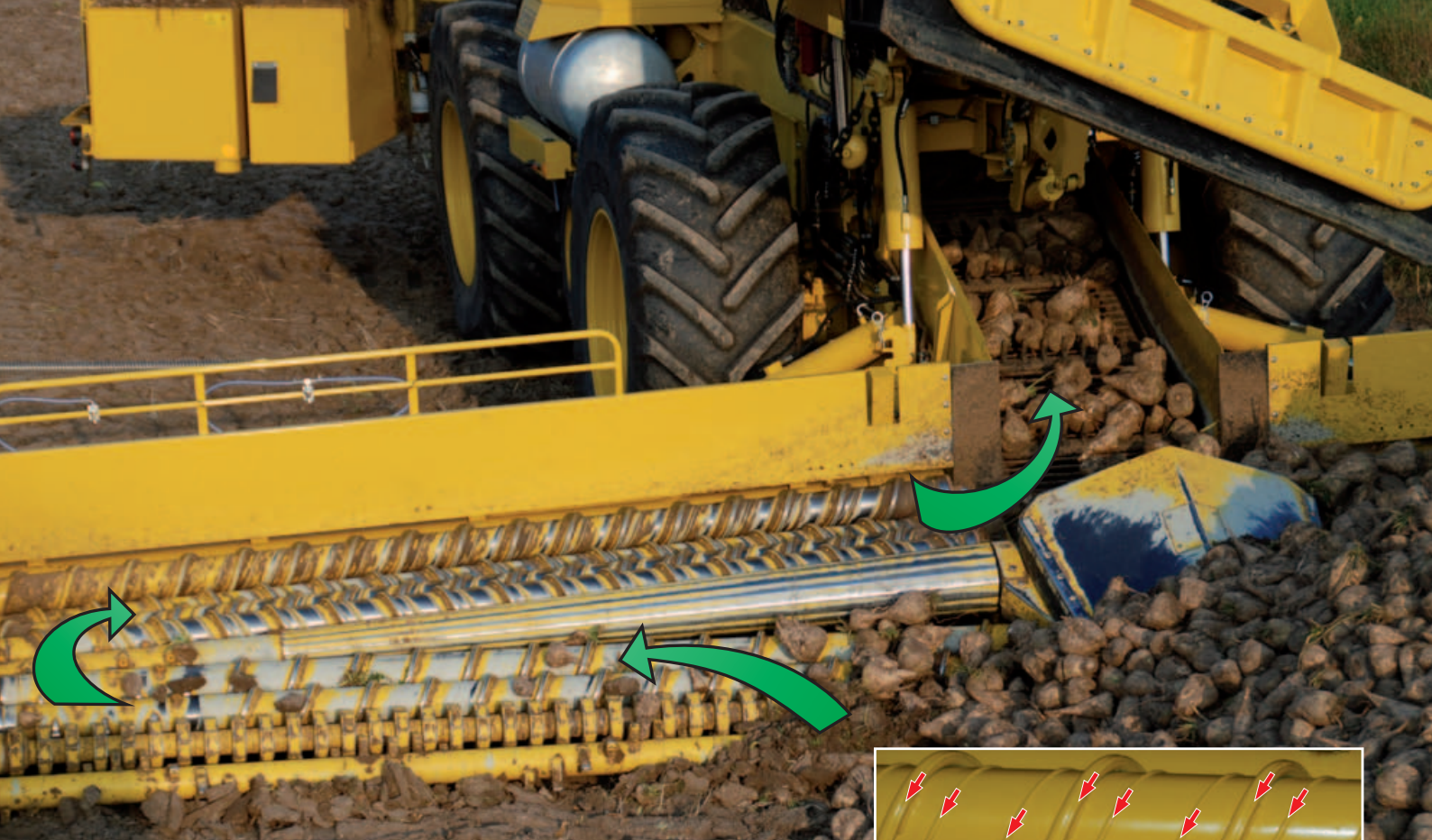
Doppelter Reinigungsweg - Die konische Walze trennt den Rübenstrom
