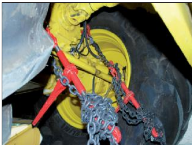
Verzurrung der Hinterachse am Tieflader mit Spannkettten
