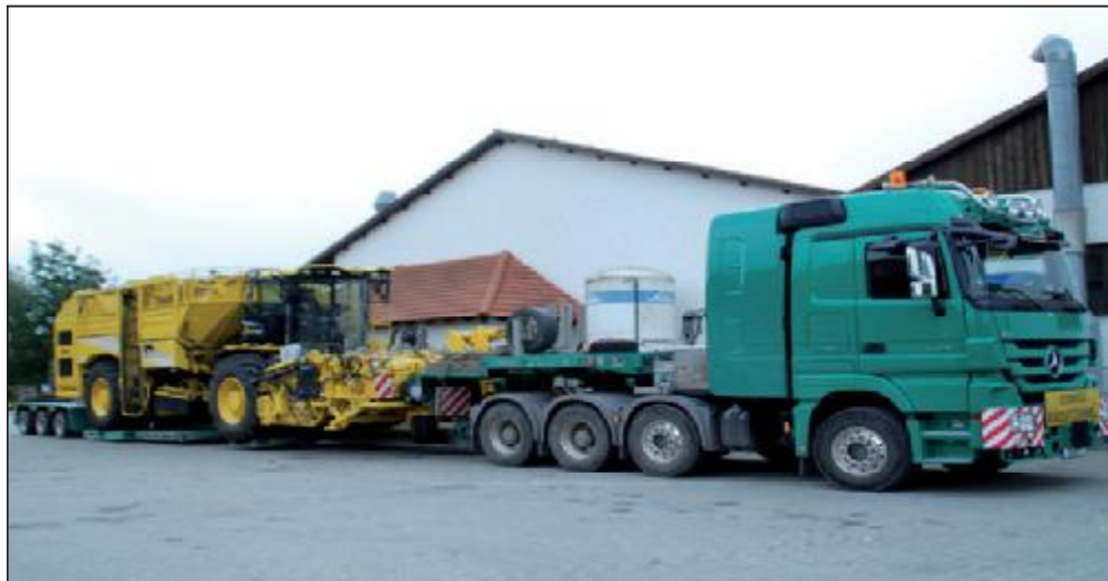
Ordentlicher Tieflader für Straßentransport mit Minimaltransporthöhe
