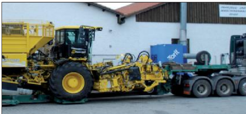
Ordentlicher Tieflader für Straßentransport mit Minimaltransporthöhe
