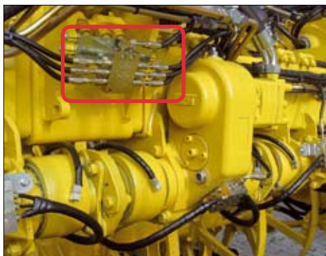
Hauptverteiler am Exzenterantrieb Rüttelschar.
