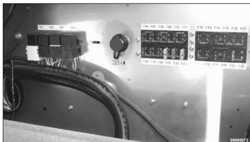
Sicherungen (F06 bis F29) von der rechten Seitenwand der Fahrerkabine zugänglich.
