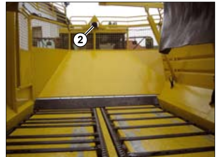
(2) Ultraschallsensor im Bunker vorne.
