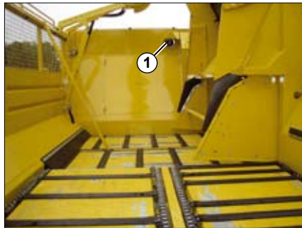
(1) Ultraschallsensor in der Bunkerrückwand.
