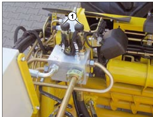
(1) Handräder Notverstellung Tastwalzendrehzahl (nicht bei XL)
