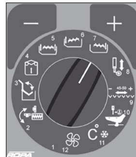
Drehwahlschalter Position 7, Bunkerschnecke nur hinten heben/senken.
