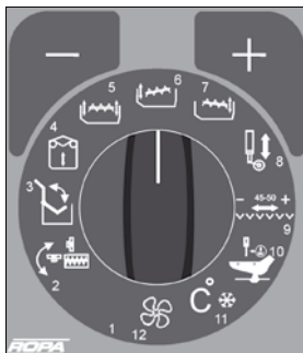
Drehwahlschalter Position 6, Bunkerschnecke nur vorne heben/senken.
