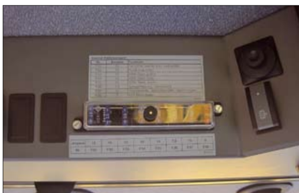
Sicherungen (F 31 bis F 38) in der Radiokonsole.
