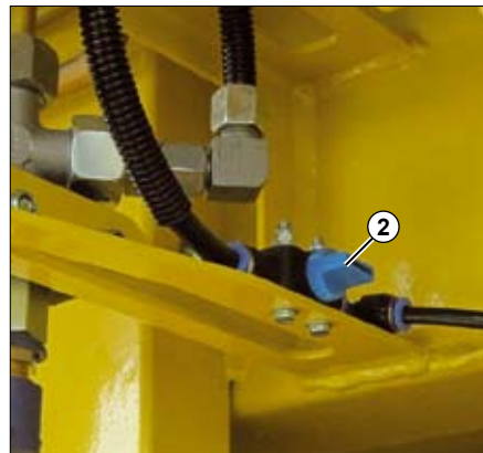
In der dargestellten Position ist der Absperrhahn (2) geöffnet. Zum Schließen um 90° drehen.
