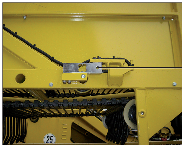
Wägezelle (2) am Rahmen des Überladers
