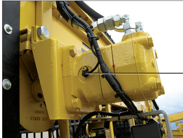
Drehzahlsensor (1) im Ölmotor des Überladers
