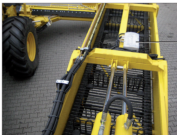
Rechner (3) für die Waage
