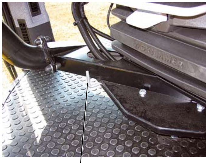
Mechanische Sitzverriegelung für Straßenfahrt
