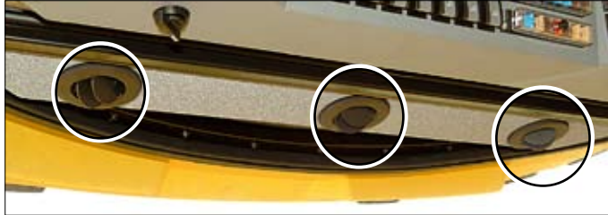
Luftdüsen in der Radiokonsole
