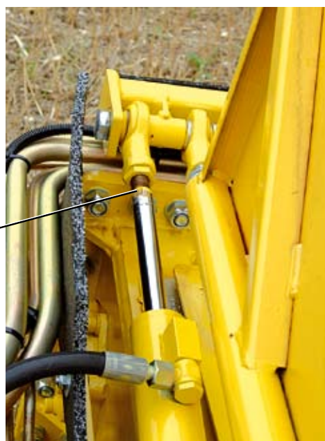
Sollbruchstelle am Klappblechzylinder
