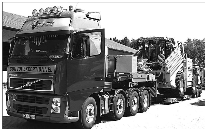
Vorschriftsmäßiger Transport mit Spezialtieflader (Fabrikat Goldhofer)
