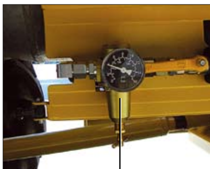
Druckminderer für die Wassersprühanlage
