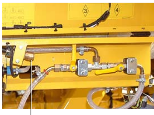
Druckluftkupplung in der Wassersprühanlage
