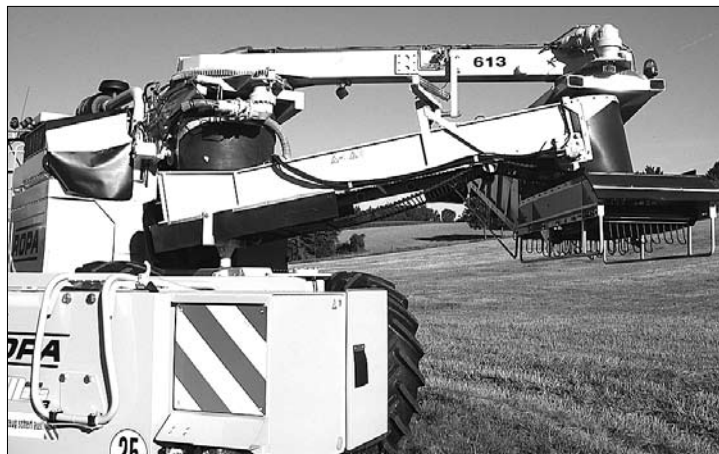
euro-maus3 Ausführung mit Siebkettenreiniger
