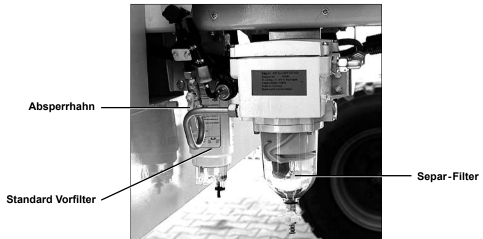
Separ-Filter: nur in Maschinen für GUS-Staaten verbaut
