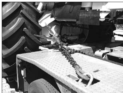
Verzurrung mit Spannkette
