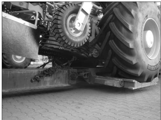
Verzurrung der Vorderachse am Tieflader mit Spannketten
