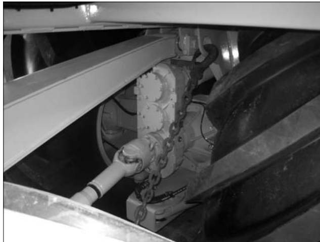
Verzurröse hinten an der vorletzten Achse (im Bild ist die rechte Kette noch nicht eingehängt)
