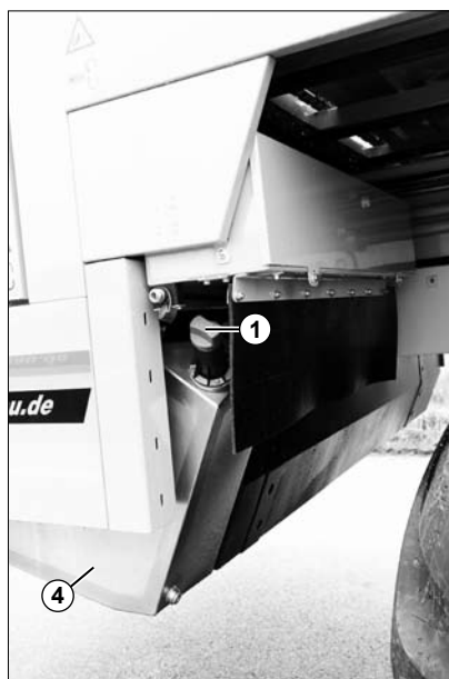
(1) Einfüllstutzen AdBlue® (4) AdBlue®-Tank
