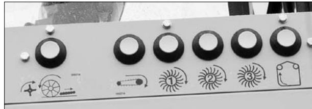
Bodenbetätigung an der linken Seite des euro-Tigers.
