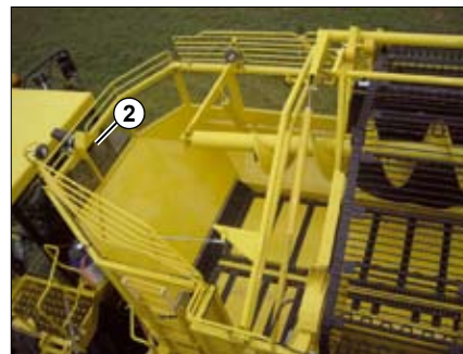
(2) Ultraschallsensor im Bunker vorne.
