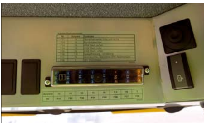
Sicherungen (F31 bis F38) in der Radiokonsole.
