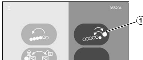
(1) Drehrichtung glatte Rodewalze
