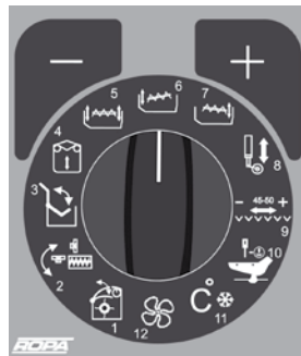
Drehwahlschalter Position 6, Bunkerschnecke nur vorne heben/senken.
