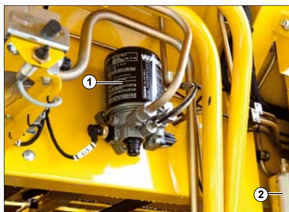
(1) Lufttrockner (2) Druckluftbehälter für Regenerierung Lufttrockner
