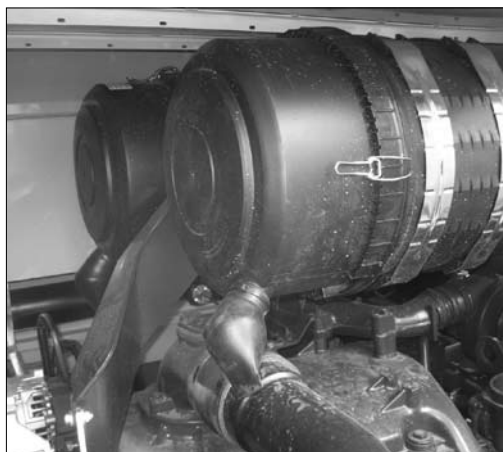
Staubaustragventil in korrekter Position
