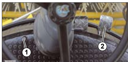
(1) Fußschalter Fahrrichtung (2) Fahrpedal
