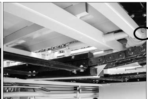
Schmiernippel an den Umlenkrollen.
