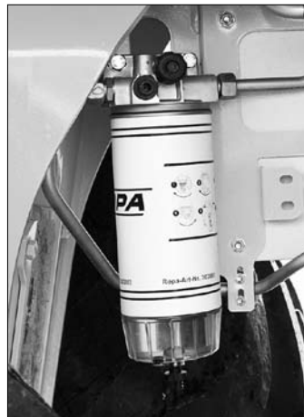
Standard-Vorfilter mit Kolbenpumpe
