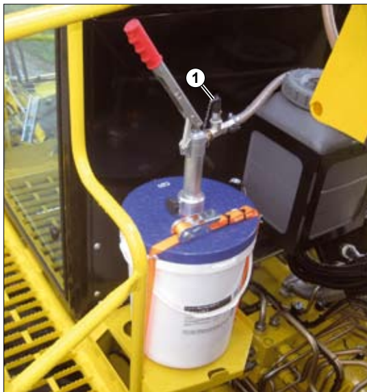
(1) Nippel zum Füllen der Handhebel Fettpresse
