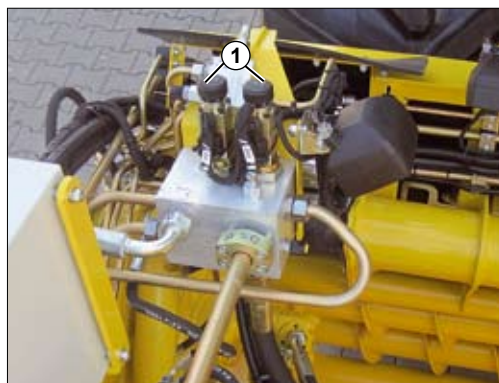
(1) Handräder Notverstellung Tastwalzendrehzahl (nicht bei XL)
