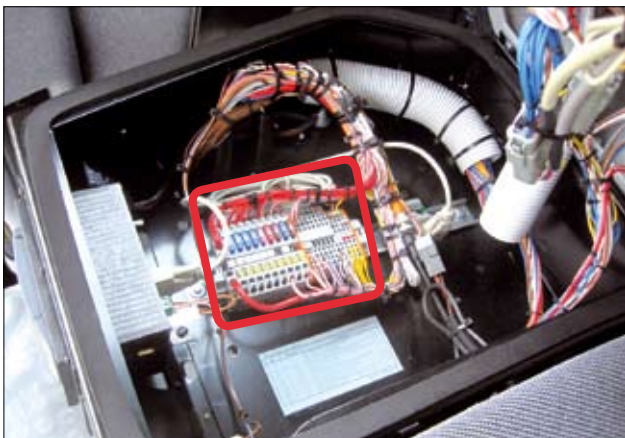
Sicherungen (F40 bis F48) in der Sitzkonsole.
