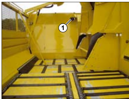
(1) Ultraschallsensor in der Bunkerrückwand.
