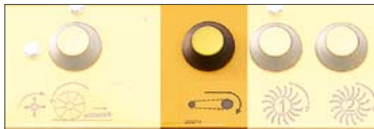
Bodenbetätigung an der linken Seite des euro-Tigers.
