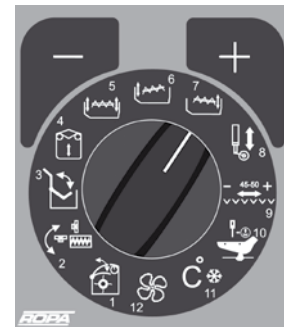
Drehwahlschalter Position 7, Bunkerschnecke nur hinten heben/senken.
