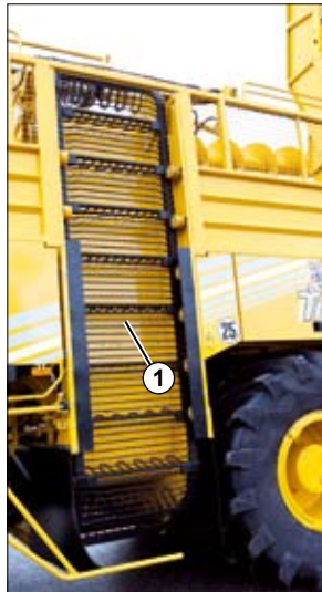
(1) Ringelevator (2) Antriebsrad rechts hinten
