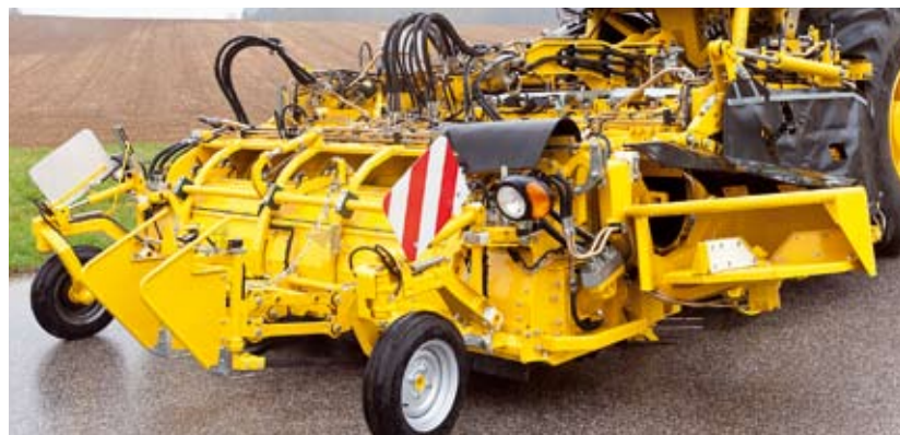
PASWh-Schlegler, Schleglerklappe unten
