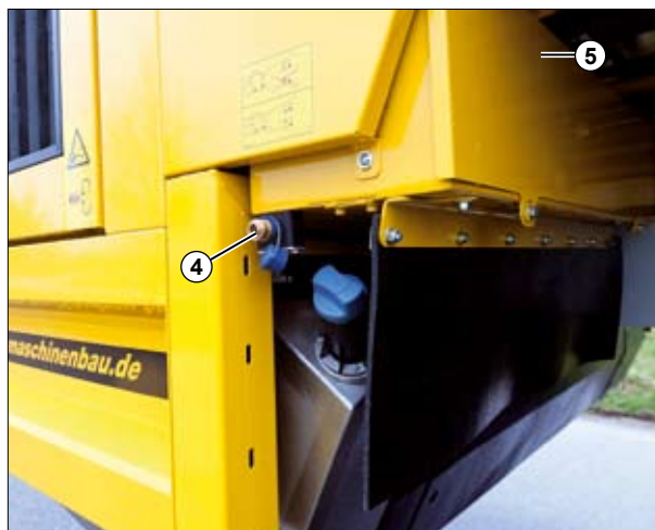
(4) Druckluftkupplung an der Außenseite des Batteriekastens
