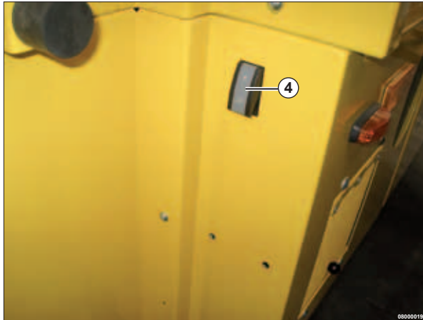
Schalter für die Aufstiegsbeleuchtung außen an der Maschine.
