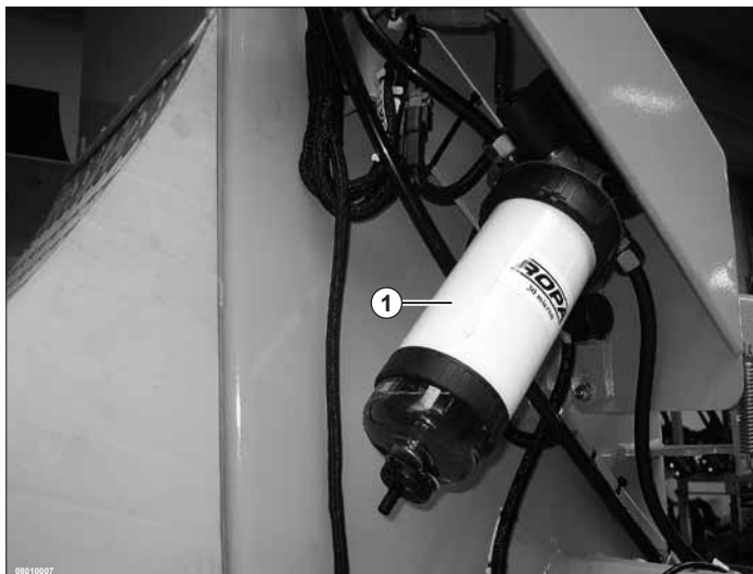
(1) Standard - Vorfilter mit Elektropumpe
