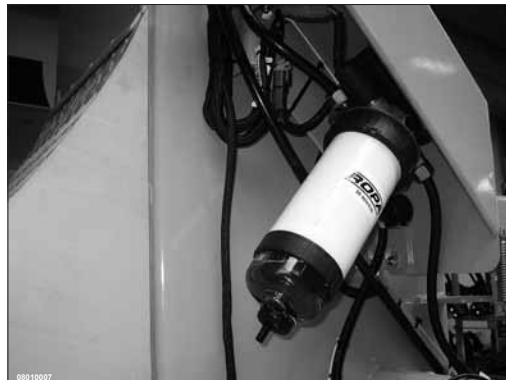
Standard-Vorfilter mit Elektropumpe
