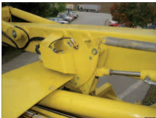
Klemmung geschlossen, Schwenkarm sicher fixiert
