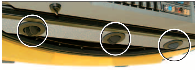
Luftdüsen in der Radiokonsole
