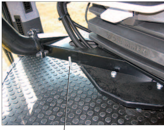
Mechanische Sitzverriegelung für Straßenfahrt
