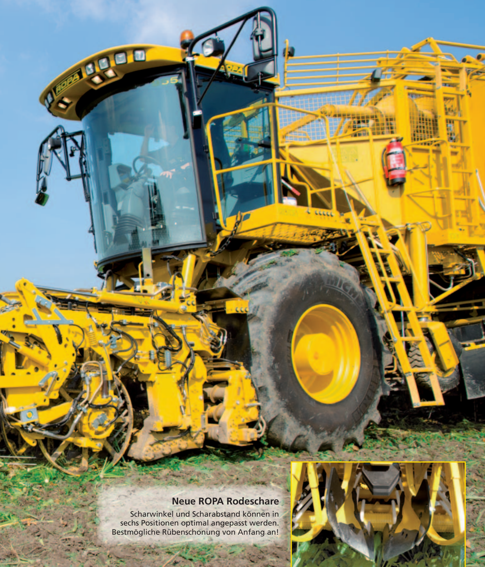
Hydraulische Höhenverstellung des Scharbalkens
