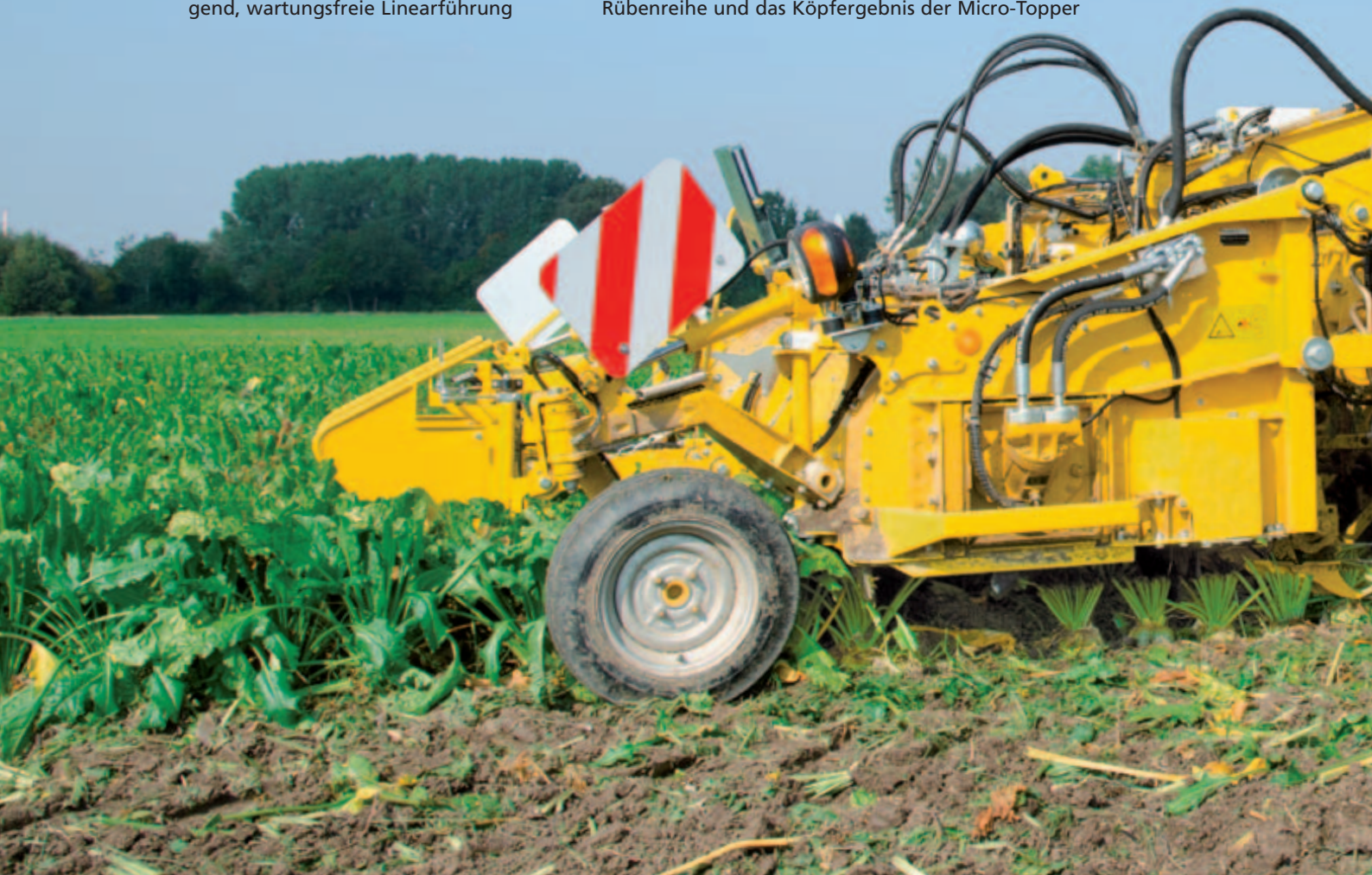
Hydraulische Steinsicherung, obenliegend, wartungsfreie Linearführung
