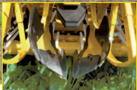
Hydraulische Höhenverstellung der Rodewalzen
