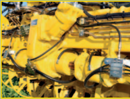
Rüttelscharantrieb mit Stirnradgetriebe und nachstellbaren Kegelrollenlagern
