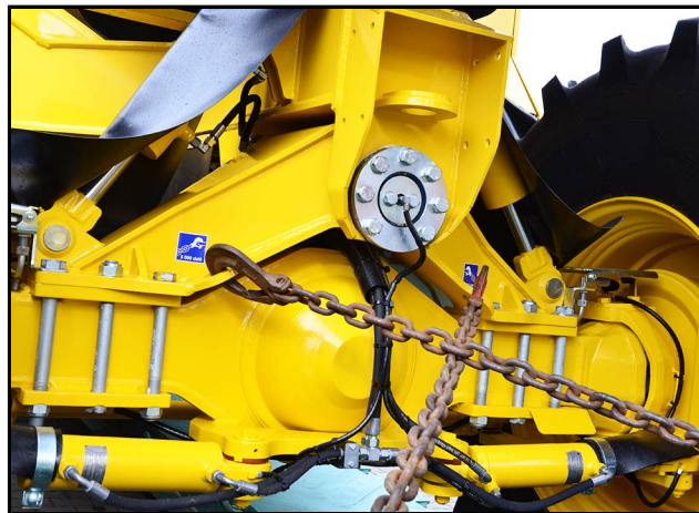
Verzurrpunkte am Hinterachsbock
