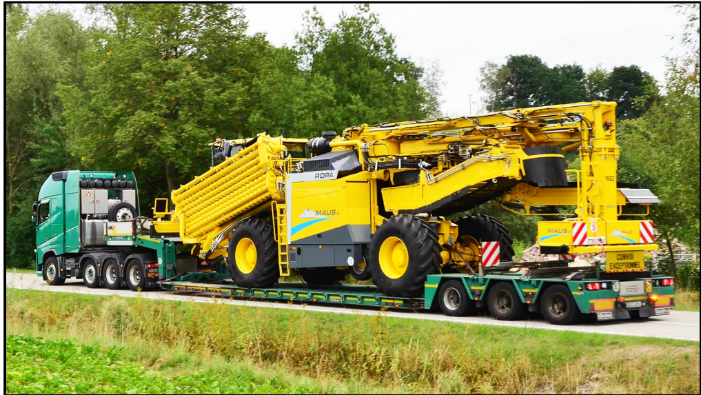
Ordentlicher Tieflader für Straßenstransport mit Minimaltransporthöhe
