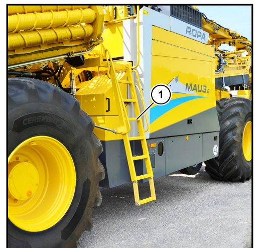
Aufstieg Fahrerkabine in Stellung Straßenfahrt bzw. Verladebetrieb
