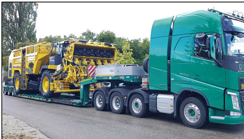
Ordentlicher Tieflader für Straßen transport mit Minimaltransporthöhe
