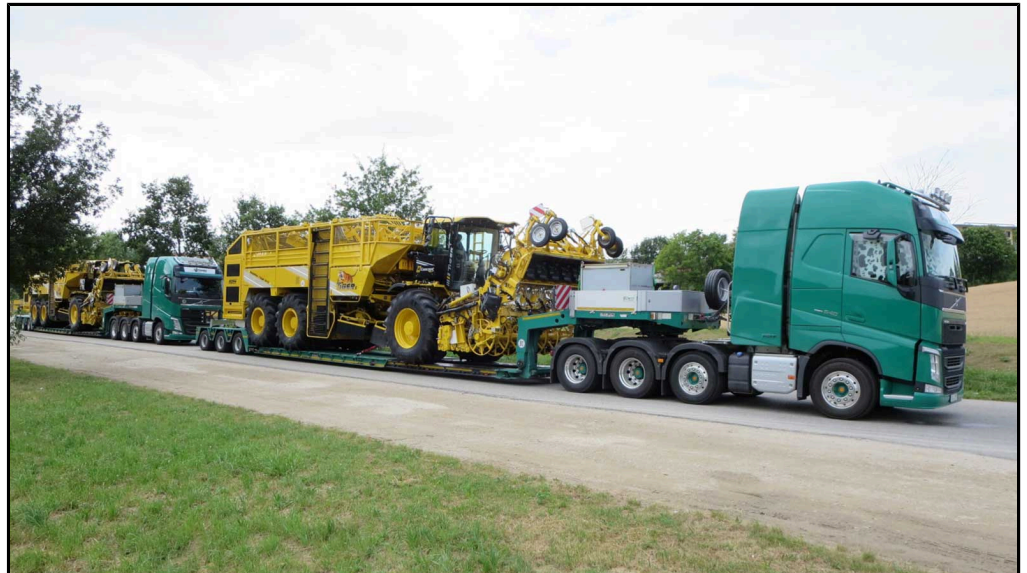
Ordentlicher Tieflader für Straßentransport mit Minimaltransporthöhe
