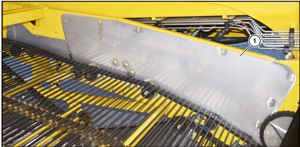
(1) Edelstahlblech links im Siebkanal
