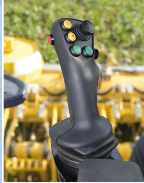
Bedienelement an der linken Armlehne zur feinfühligsten Steuerung der Bunkerentleerung
