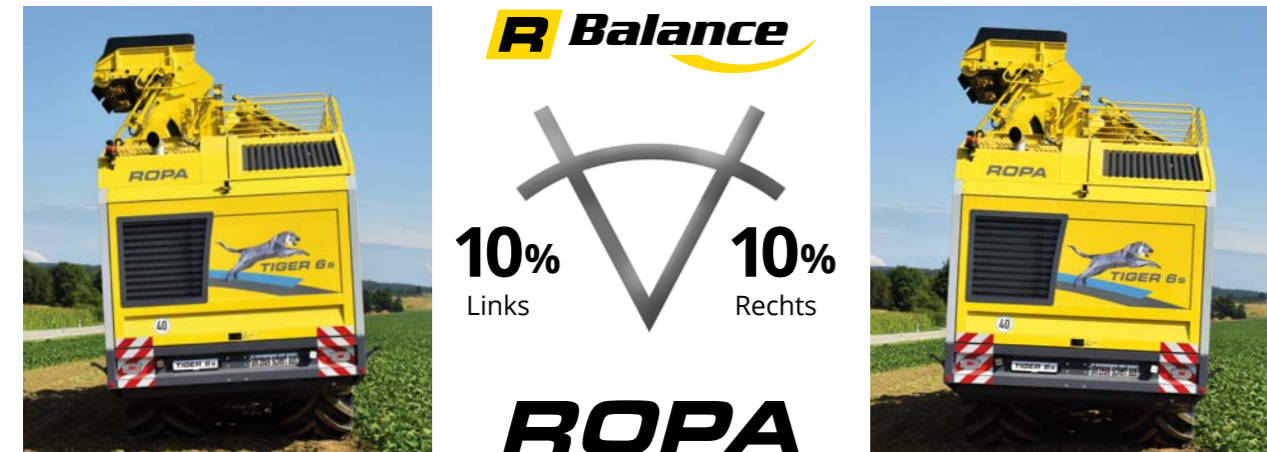
Am Hang wird die Last und der Schwerpunkt von der Hangunterseite zur Hangoberseite verlagert: Bodenschonende Rübenernte auch am Seitenhang!
