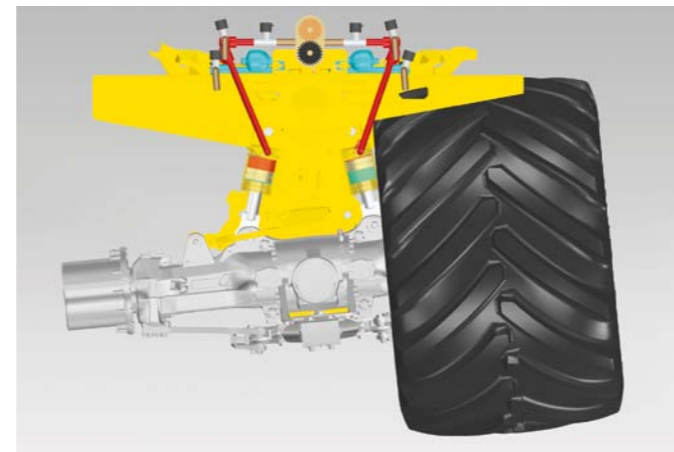
Hydraulisches Fahrwerk, automatischer Hangausgleich
