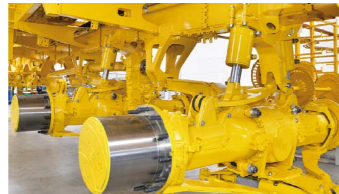
Hydraulisches Fahrwerk, automatischer Hangausgleich
