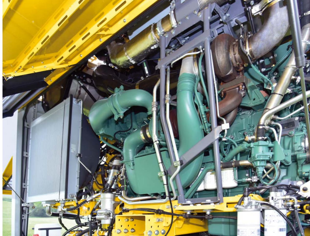
Volvo Penta TWD1683VE - die Basis für höhere Tagesleistungen bei weniger Kraftstoffverbrauch, noch mehr Kraft bei niedrigen Drehzahlen.
