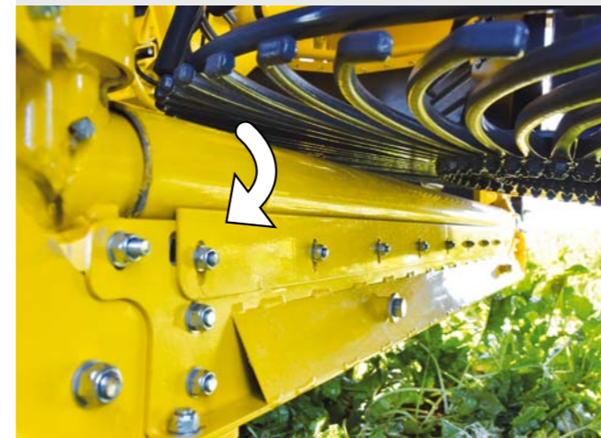
Drehende Übergangsrohre am Elevator-einlauf verhindern Erdaufbau
