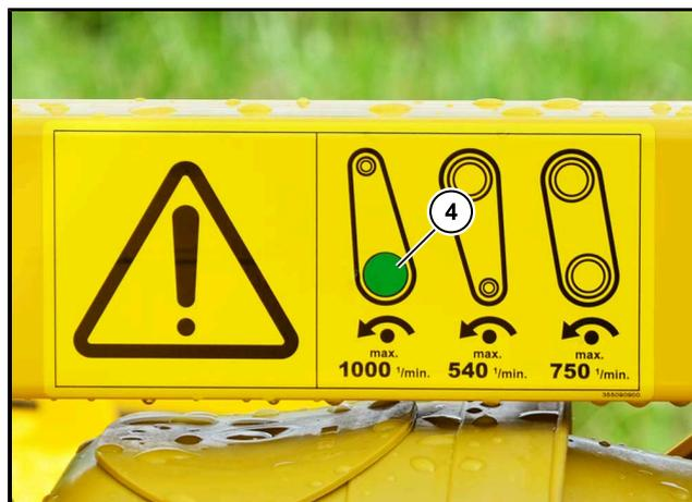
(4) Markierung maximal zulässige Eingangs-Drehzahl
