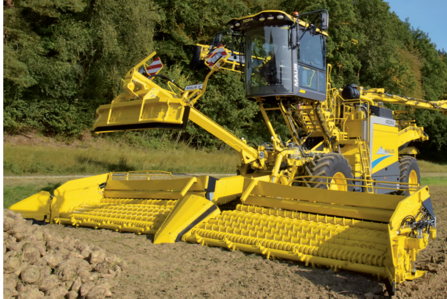
Separate Antriebe für 3 Walzengruppen mit individueller Drehzahlanpassung und automatischer Reversierung bei Steinklemmer. Sämtliche Walzen sind serienmäßig hart aufgeschweißt.
