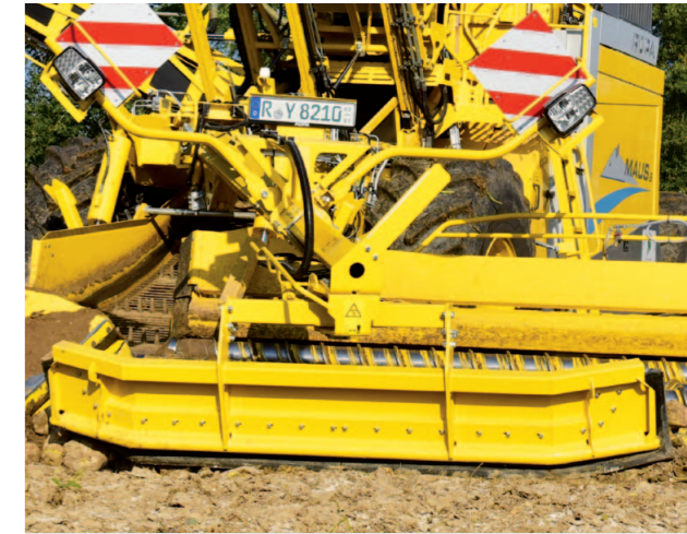
Mietenabräumer und Restrübenaufnehmer mit abgewinkelten Ecken und verstärkter Gummilippe.
