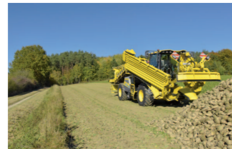
Separate Antriebe für 3 Walzengruppen mit individueller Drehzahlanpassung und automatischer Reversierung bei Steinklemmer. Sämtliche Walzen sind serienmäßig hart aufgeschweißt.
