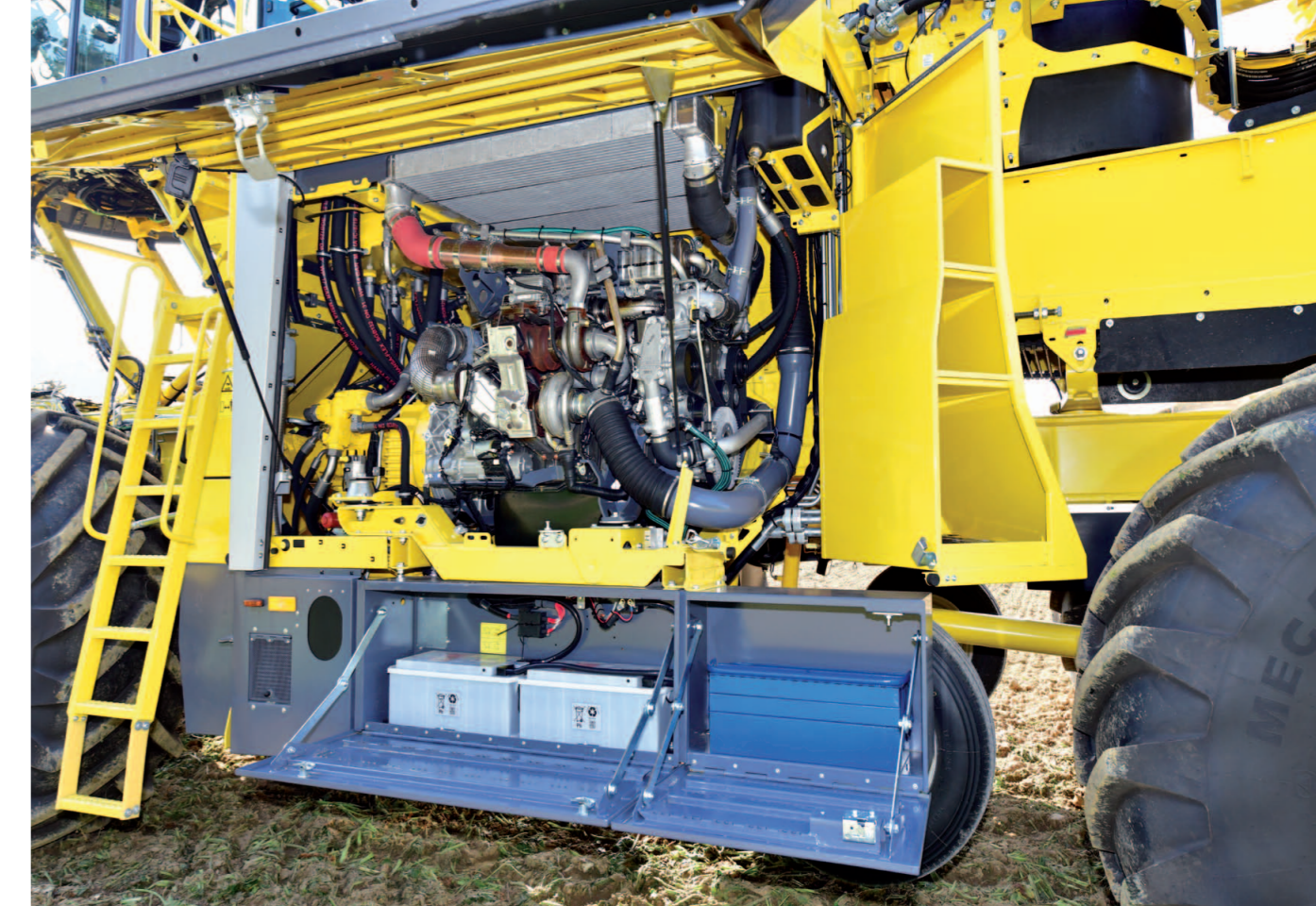
Mercedes-Benz OM936 - Für einen Verladebetrieb mit stark reduzierter Motordrehzahl (ab 1.150 1/min möglich) und reichlich Kraftreserven bei Extrembedingungen.
