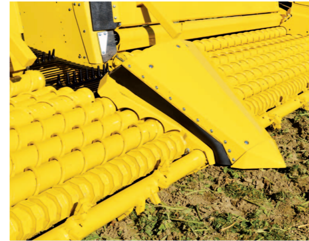
Mittelspitz mit wechselbarer Spitze und geteilter Haube - spielfreier Antrieb mit Kegelrollenlager und automatischer Schmierung.
