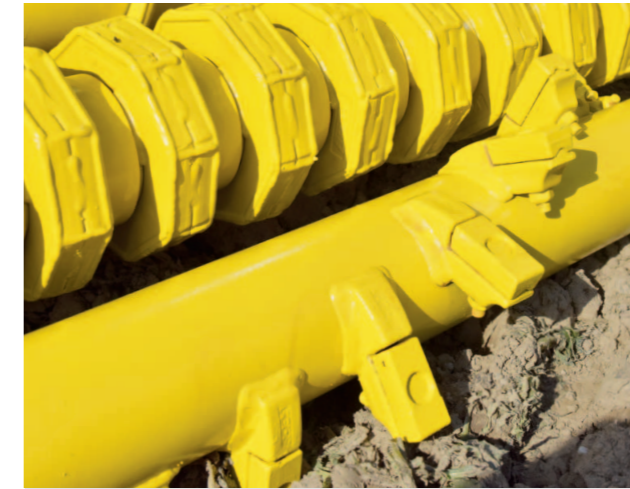
Verschleißfeste, austauschbare Aufnahmefinger mit Hartmetallplatte, Putzerwalzen mit geschmiedeten Achteck-Scheiben und Hartauftrag.
