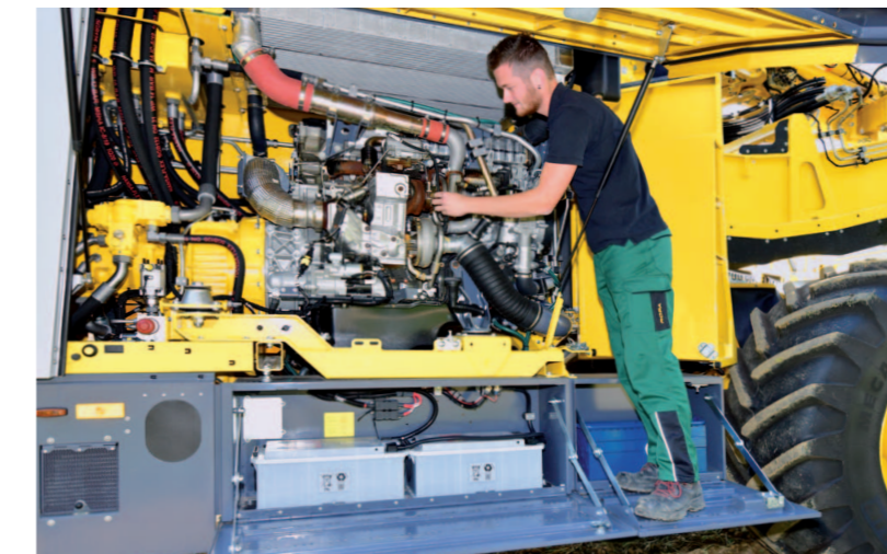
Mercedes-Benz OM936 - Für einen Verladebetrieb mit stark reduzierter Motordrehzahl (ab 1.150 1/min möglich) und reichlich Kraftreserven bei Extrembedingungen.
