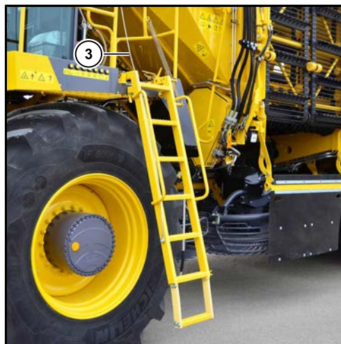
Aufstieg Fahrerkabine in Stellung Straßenfahrt bzw. Rodebetrieb
