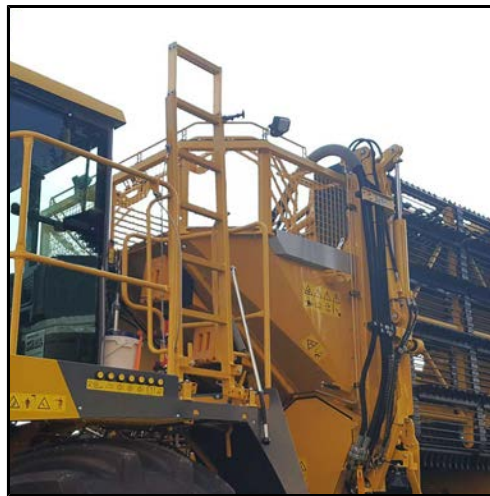
Aufstieg Fahrerkabine in Stellung Straßenfahrt bzw. Rodebetrieb
