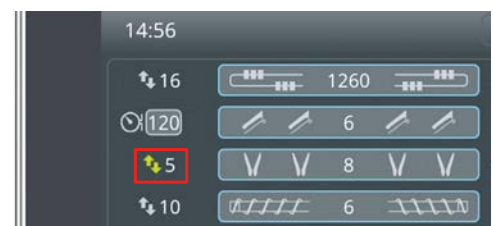
Automatische Schartiefenverstellung aktiv
