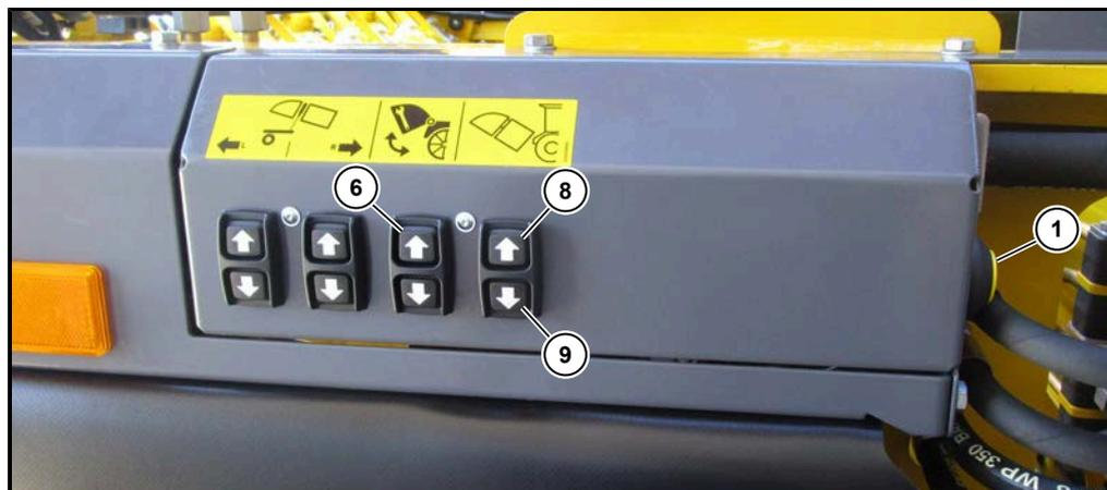
Alternativ zum R-Select gibt es die Bodenbetätigung am Rodeaggregat. Drücken Sie dazu die Taste Schlegler-Wartungsstellung (6) und zusätzlich den Totmanntaster (1).
