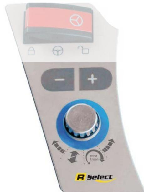
**6.19.4 Bunkerschnecke Drehrichtung umschalten**
