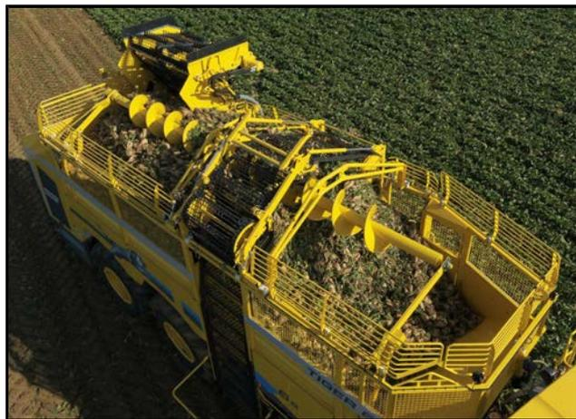
In **Rodestellung** ist der Ringelevator ausgeklappt, die Bunkerschnecke so eingestellt, dass die Zuckerrüben gleichmäßig verteilt werden, das Entladeband senkrecht gestellt und die Knickteile des Entladebandes in Rodestellung geklappt. Die Bunkerschnecke ist dabei üblicherweise bis zum Anschlag hoch gehoben.
