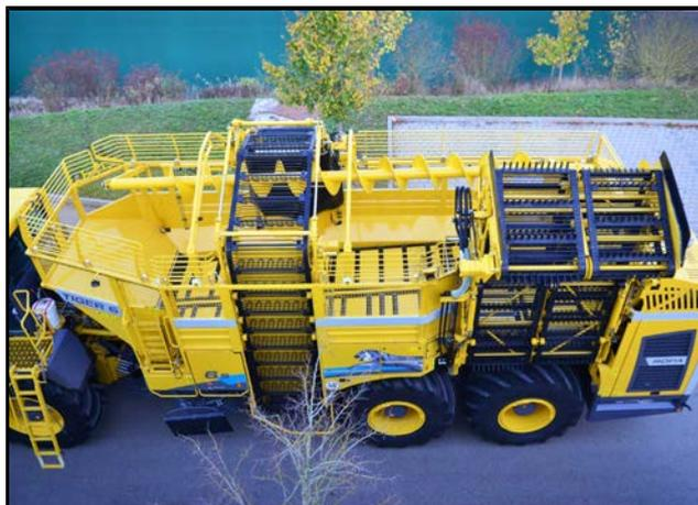
*Der Bunker ist vollständig in Rodestellung ausgeklappt.*
