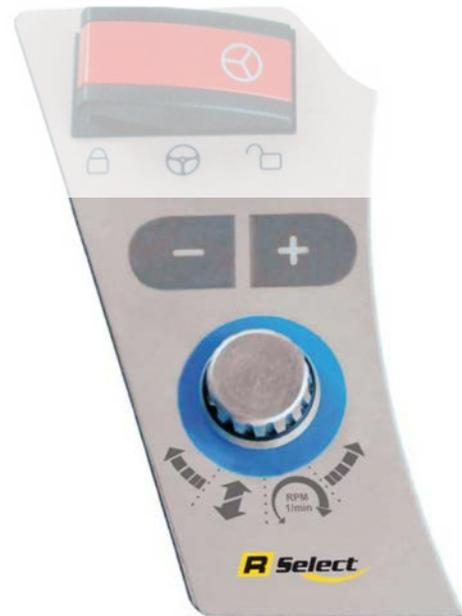
Wird in der Stufe 1 die - Taste gedrückt und in dieser Stellung mehrere Sekunden festgehalten, schaltet der Blatttellerantrieb ab.
