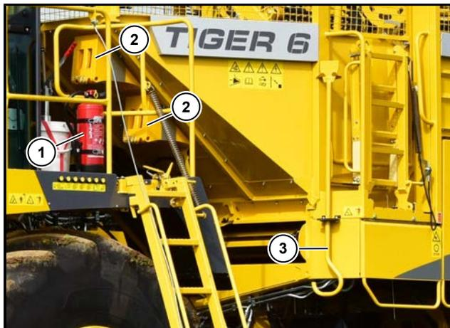
Verstauen Sie das mitgelieferte Zubehör wie z. B. Feuerlöscher (1), Unterlegkeile (2), Putzereisen (3), Werkzeugkasten in den dafür vorgesehenen Fächern oder Halterungen.
