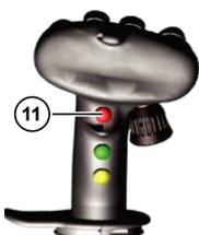
Der Kreuztaster (4) ist mit folgender Doppelfunktion belegt: Werden Kreuztaster (4) und Multitaster (11) gleichzeitig gedrückt, verstellt sich die Schleglertiefe auf beiden Seiten gleichzeitig, egal nach welcher Seite Sie den Kreuztaster bewegen.
