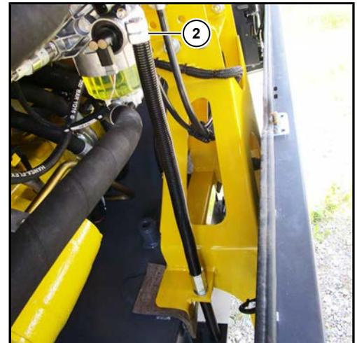
Für einen besseren Zugang zur Unterseite der Hydraulikpumpen im Motorraum kann der Kraftstofftank wie folgt abgeklappt werden:
