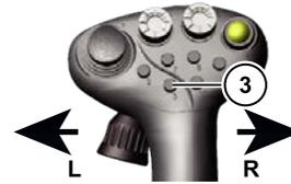
Synchronlenkung aktivieren. Dazu Lenkungshauptschalter (44) verriegeln. Knick und Vorderachse werden automatisch synchronisiert. Siehe Abschnitt Knicklenkung synchronisieren (siehe Seite 198).
