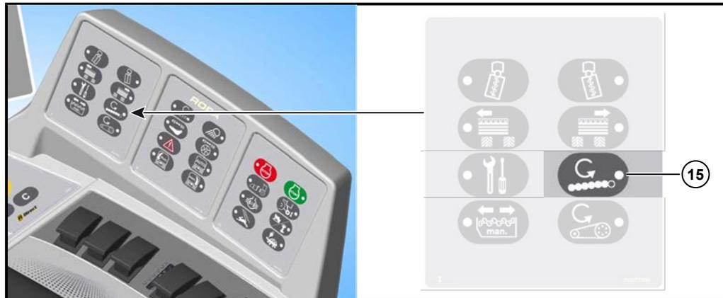
Solange diese Taste gedrückt wird, drehen sich Schleglerwelle, Blattschnecke, Paddel und die Rodewalzen mit reduzierter Drehzahl rückwärts. Sobald diese Taste wieder losgelassen wird, schaltet der Roderhauptantrieb um und alles läuft wieder vorwärts.
