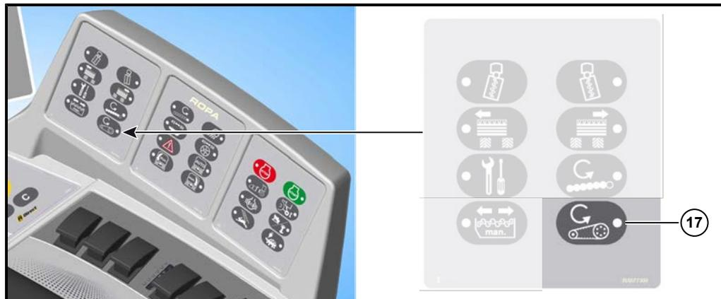
Damit haben Sie die Möglichkeit den Schmutz, der sich zwischen dem oberen und unteren Band bei sehr klebrigem Boden ansammeln kann, leichter zu lösen und somit besser entfernen zu können. Drücken Sie dazu, bei ausgehobenem Roder und leergelaufenem Band, mehrmals die Reversiertaste (17).
