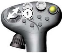
Die Richtung des Schonganges links oder rechts wird mit dem Mini-Joystick (1) vorgewählt. Dazu Mini-Joystick (1) nach links/rechts schieben und ca. 1 Sek. festhalten (Schongang li/re vorwählen).
