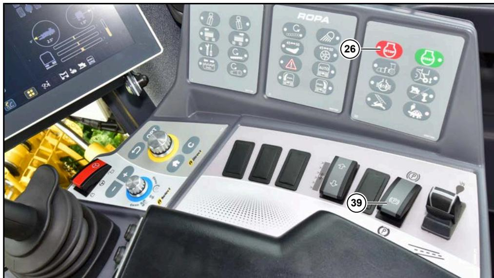
Diese Sicherheitsschaltung umgeht das Standard-Regelverhalten der Hydraulik und öffnet ein Sicherheitsventil, das den Fahrtrieb schnell abschaltet. Sollte bei einem äußerst unwahrscheinlichen Versagen aller Sicherheitseinrichtungen die Maschine trotzdem nicht stoppen, ist schnellstens der Dieselmotor an der STOP-Taste (26) oder am Zündschloss abzustellen. (siehe Seite 87) (siehe Seite 160)
