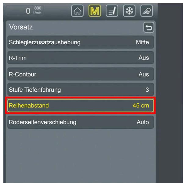
Diese Einstellung bestimmt, wie weit sich mit dem Kippschalter "Walzengang verschieben" der Walzengang seitlich verschieben lässt. Ebenso wird dadurch die seitliche Positionierung des Walzengangs bei der Seitenverschiebung des gesamten Roders an den Abstand zur nächsten Rübenreihe angepasst.
