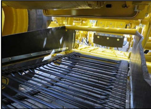
Das Siebband läuft unter der Vorderachse hindurch und transportiert die Rüben vom Rodeaggregat zum ersten Siebsterne.
