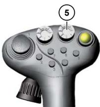
Die Höhenverstellung des Walzengangs erfolgt durch diagonales Schieben oder Ziehen des Kreuztasters (5) am Joystick.
