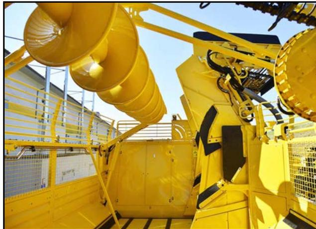
Rohr und Windungen der Bunkerschnecke sind regelmäßig von anhaftender Erde oder anderen Fremdkörpern zu reinigen.
