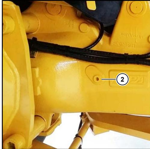
Öleinfüllöffnung und Ölstandskontrollschraube (2) auf der linken Vorderseite der Achse.
