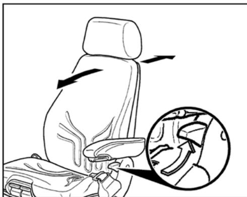
Das Verstellen der Rückenlehne erfolgt über den Verriegelungshebel (Pfeil).
