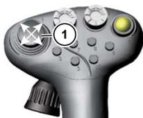
**(1) Mini-Joystick (1)** vor/zurück (Dreipunkt senken/Dreipunkt heben, nur bei laufendem Dieselmotor)
