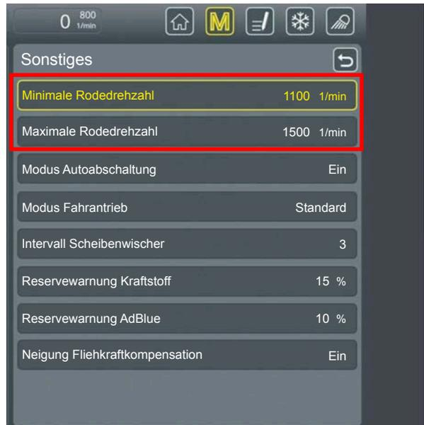
Sollten die Werte für „Minimale Rodedrehzahl“ und „Maximale Rodedrehzahl“ gleich hoch eingestellt sein, ist das automotiv Roden deaktiviert.
