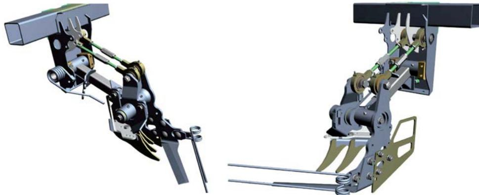
Der Nachköpfer MT2 ist ein Köpfer mit parallel geführten Köpfmessern (Parallelköpfer). Er entfernt den Blattansatz, der nach dem Abschlegeln des Blattes noch am Rübenkörper bleibt. Achten Sie darauf, dass die Nachköpfermesser immer ausreichend geschärft sind.
