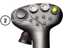
Es gelten die bereits genannten Voraussetzungen zum Aktivieren des Schongangs. Wie der Name bereits sagt, dient die Lenkungsvariante „Wendefahrt“ fast ausschließlich zum Wenden der Maschine auf kleinstem Raum.
