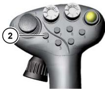
Es gelten die bereits genannten Voraussetzungen zum Aktivieren des Schongangs. Zum Aktivieren der Lenkungsvariante „Hundegang“ Multitaster (11) drücken, festhalten und dann Taste (2) am Joystick 1 Sekunde lang gedrückt halten. Es bewegen sich nun die Hinterräder in die selbe Richtung, in die die Vorderräder gelenkt werden. Das Fahrzeug kann somit diagonal z. B. an die Miete herangefahren werden.
