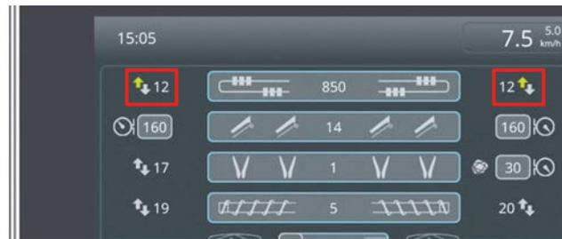
Wird durch die Funktion "R-Trim" die Schleglerhöhe verstellt, dann sind beide Doppelpfeile bei der Anzeige der Schleglerhöhe komplett grün eingefärbt. Neben der Zahl der manuell eingestellten Schleglerhöhe erscheint eine grün eingefärbte Zahl, die die momentane Schleglerhöhe anzeigt, die durch das R-Trim eingeregelt wird.
