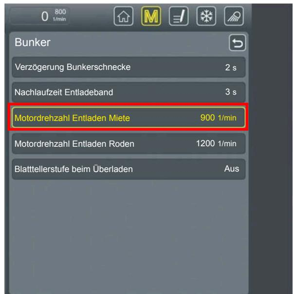
Wenn der Bunker während des Rodens auf ein nebenherfahrendes Fahrzeug entleert wird, wird die Drehzahl des Dieselmotors automatisch auf 1200 min<sup>-1</sup> eingeregelt. Sollten Sie jedoch eine andere Drehzahl des Dieselmotors wünschen, können Sie dies im Menü „Grundeinstellungen“, Untermenü „Bunker“, in der Zeile „Motordrehzahl Entladen Roden“ einstellen.
