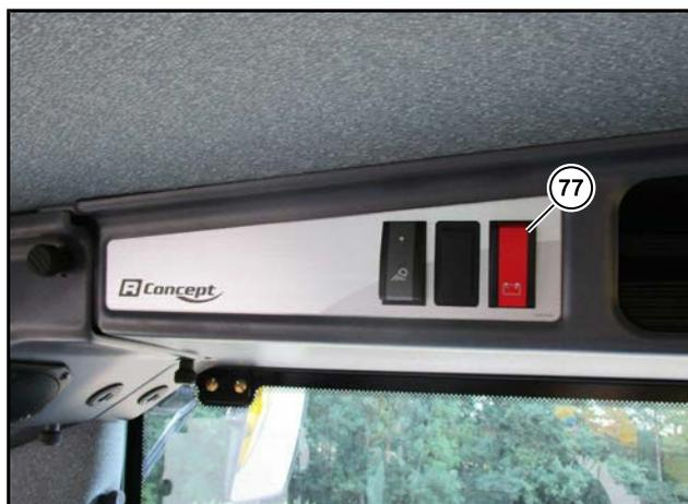
Wenn Sie am Batterie Hauptschalter (77) die Stromversorgung abschalten (nach oben = AUS, nach unten = EIN), so schaltet diese erst 6 Minuten später ab (vorausgesetzt das Zündschloss befindet sich in Stellung 0). Sollten Sie das Abschalten des Batterie Hauptschalters (77) vergessen, so schaltet 120 Stunden nach Abschalten der Zündung das Batterietrennrelais selbständig ab. In diesem Falle müssen Sie vor dem nächsten Einschalten der Zündung den Batterie Hauptschalter (77) einmal AUS/EIN-schalten.
