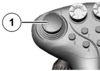
Im "Ankoppelmodus Kettenzüge" können mit dem Mini-Joystick (1) die Kettenzüge rechts und links getrennt angesteuert werden.
