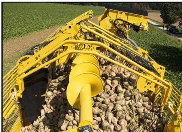
Zum Roden muss der Elevator grundsätzlich bis zum Anschlag ausgeklappt sein. Der Elevator ist dann von den beiden Stützzylindern (1) in der obersten Position fixiert. Die beiden Stützzylinder werden vom Elevatorantrieb gespeist und nach dem Einschalten des Antriebs immer bis auf Anschlag ausgefahren.
