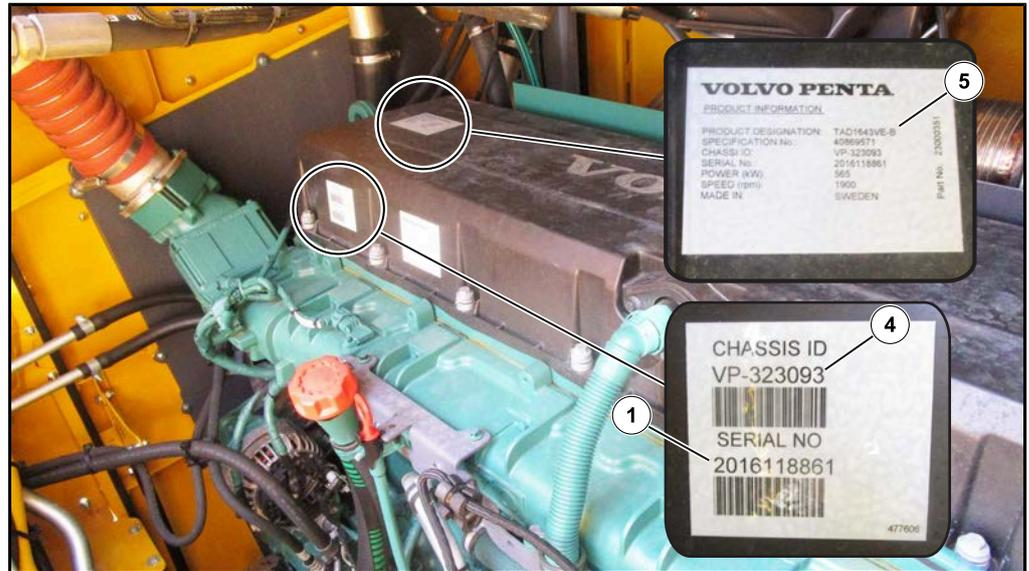
Die Seriennummer des Motors (1), die Volvo Penta Chassis ID (4) und der Motortyp (5) befinden sich am Ventildeckel des Motors. Diese Informationen können von der Bunkerrückwand aus am Motor abgelesen werden.
