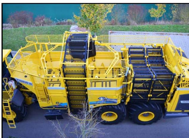
2. Bunkerbügel und die vordere Bunkerwand ausklappen. (*siehe Seite 316*)
