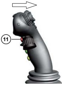
Soll der Schlegler manuell angehoben werden ohne gleichzeitig das Rodeaggregat zu heben, halten Sie den Multitaster (11) gedrückt und ziehen Sie den Joystick nach hinten. Dabei wird der Schlegler von den Schleglerentlastungszyindern maximal angehoben. Sobald sie den Mini-Joystick (1) kurz nach vorne schieben, wird die Zusatzaushebung abgeschaltet. Gleichzeitig wird die Entlastungsdruckregelung der Schleglerentlastungszyylinder aktiviert und der ursprüngliche Entlastungsdruck eingeregelt.
