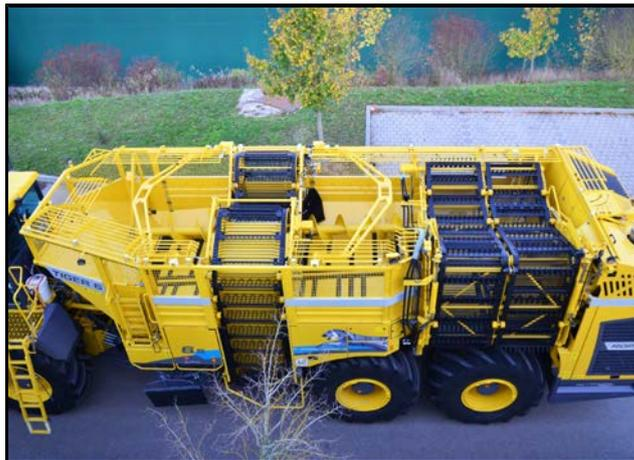
*Der Bunker ist vollständig in Transportstellung eingeklapp.*
