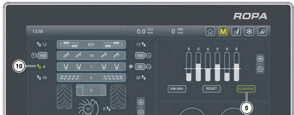
Zum Einschalten der automatischen Schartiefenverstellung drücken Sie auf das Schaltfeld "R-CONTOUR" (5). Im R-Touch erscheint das Schaltfeld in grün und bei der Anzeige für die Schartiefe (10) im Anzeigebereich Roder/Schlegler wird der linke Pfeil grün eingefärbt. Die automatische Schartiefenverstellung ist eingeschaltet aber noch nicht aktiv.
