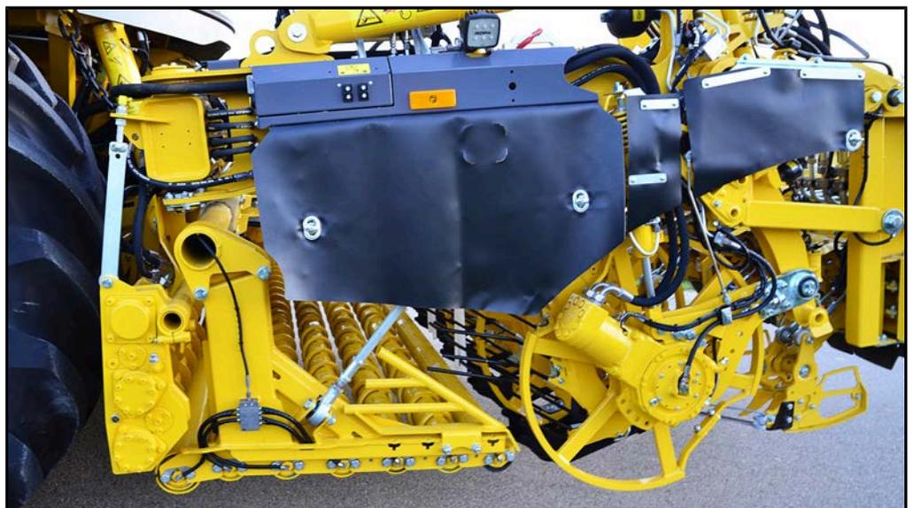
Das Rodeaggregat ist mit zwei Unterlenkern und einem Oberlenker (deshalb auch "Dreipunkt" genannt) über ein Koppeldreieck an das Fahrgestell der Maschine angebaut.
