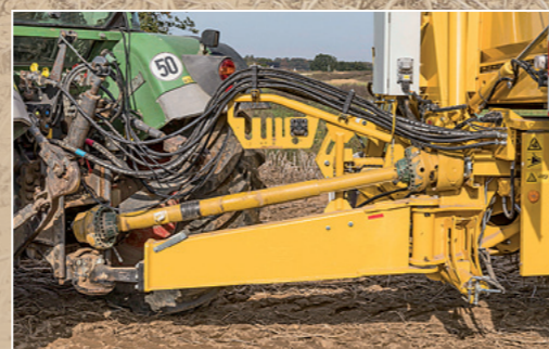
Vorbildlich: Von der Lenkung bis zur Schlauchgarderobe und -führung gibt es keine Kritik.
