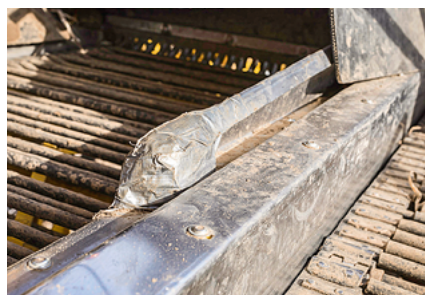
Scharfe Kanten an der Edelstahlauskleidung (hier mit Klebeband optimiert) sollten ab Werk vermieden werden.
