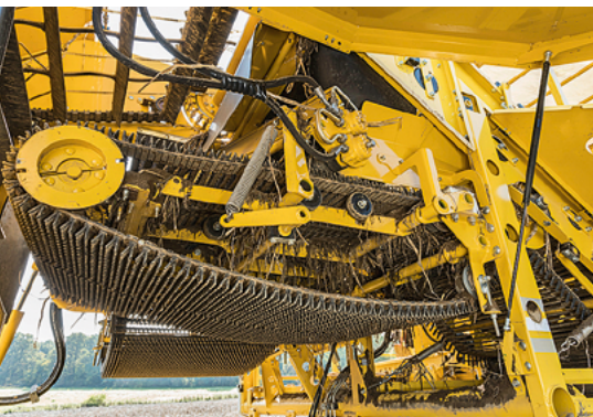
Am ersten Trenngerät transportieren zwei Igelbänder den Gutstrom: ein breites und ein schmales.
