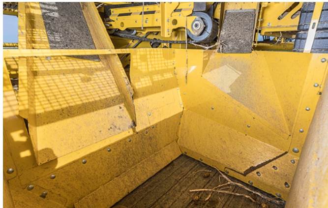
Nicht für jede Region sind die Fallschächte zum Steinekasten ausreichend groß dimensioniert. Fotos: Touvornik, Schulz
