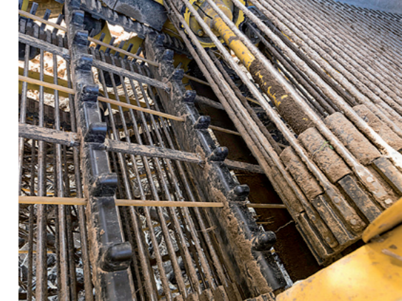
Der Übergang von der ersten auf die zweite Siebkette überzeugte nicht komplett.
