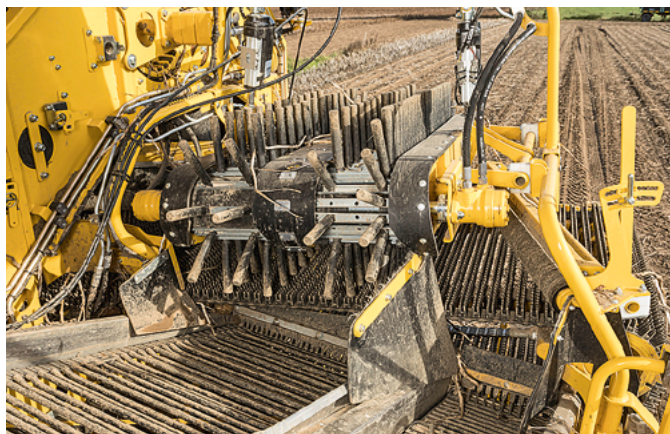
Der vierreihige Fingerkamm leistet gute Arbeit. Er lässt sich in der Geschwindigkeit und Höhe feinfühlig verstellen.
