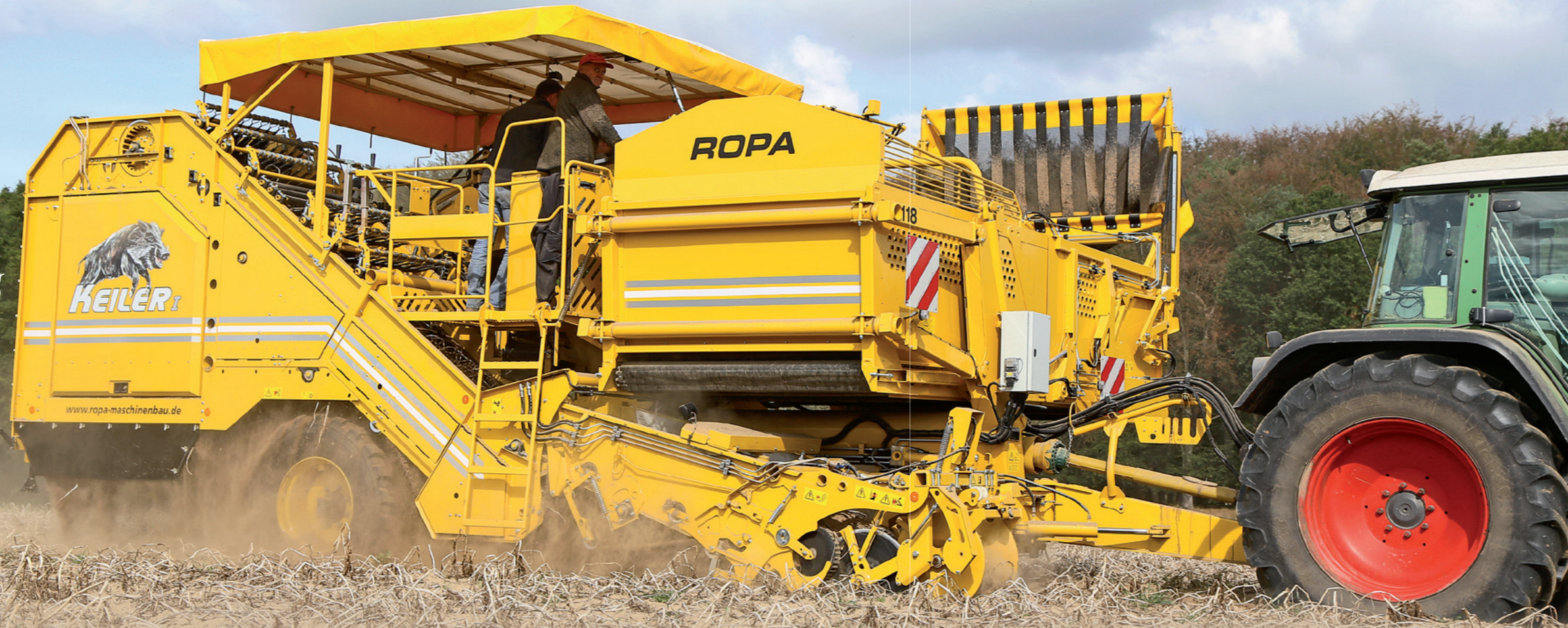
Mit dem zusätzlichen Scheibensech an der rechten Seite und der optionalen Dammdruckregelung arbeitete die Aufnahme überwiegend störungsfrei. Ropa bietet verschiedene Scharplatten an.
