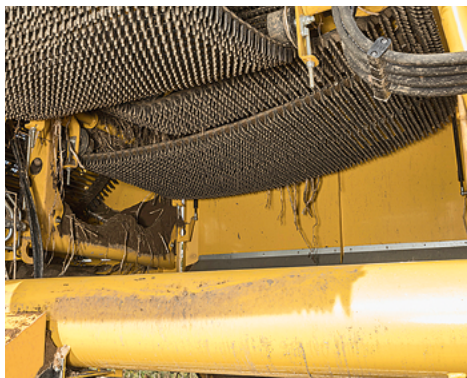
Am ersten Trenngerät transportieren zwei Igelbänder den Gutstrom: ein breites und ein schmales.
