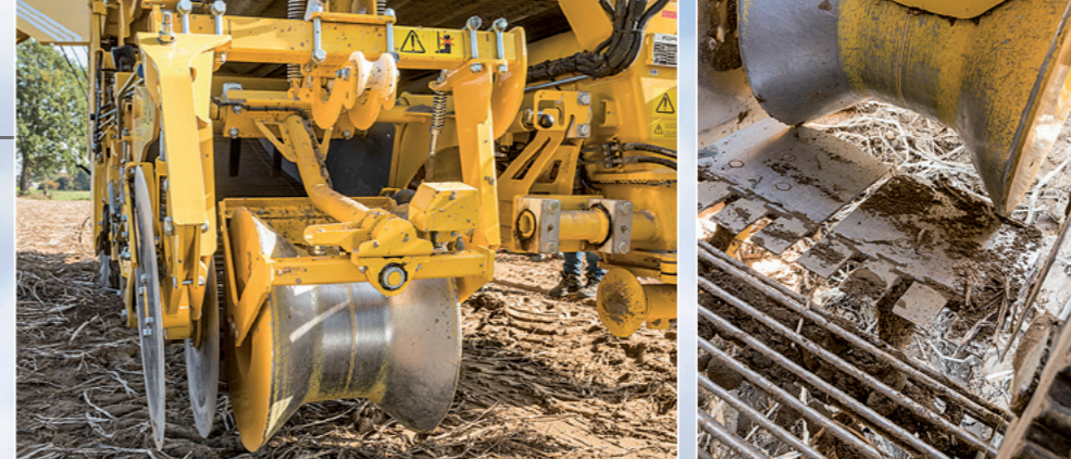
Mit dem zusätzlichen Scheibensech an der rechten Seite und der optionalen Dammdruckregelung arbeitete die Aufnahme überwiegend störungsfrei. Ropa bietet verschiedene Scharplatten an.
