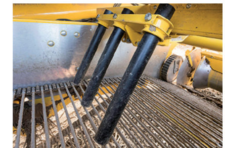
Am optionalen Rührwerk im Siebkanal wäre eine werkzeuglose Winkelverstellung hilfreich.
