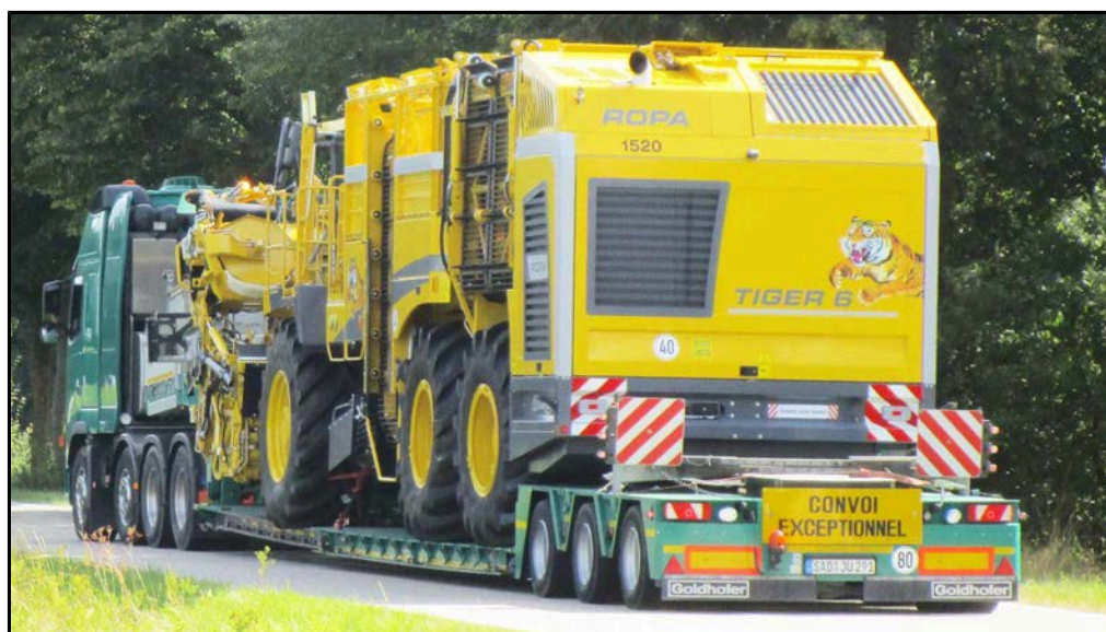
Ordentlicher Tieflader für Straßenstransport mit Minimaltransporthöhe
