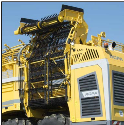
Entladebandknickteil 1 und 2 in Rodestellung
