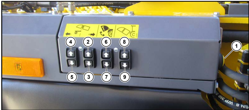
Bodenbetätigung Rodeaggregat links
