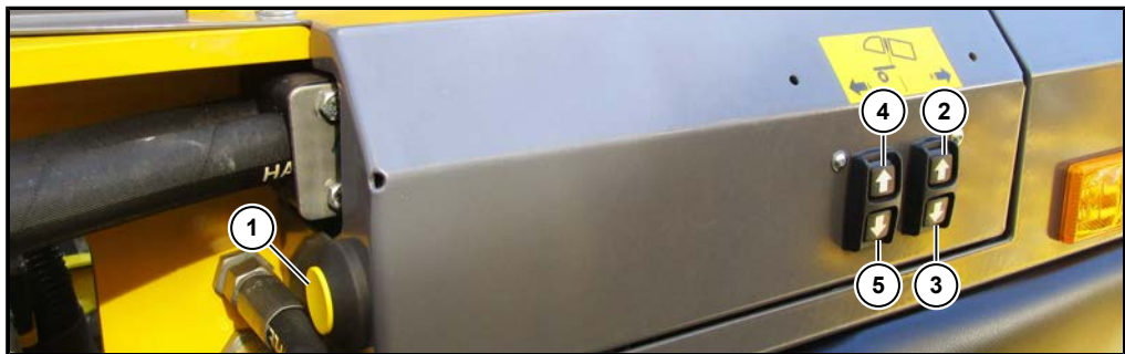
Bodenbetätigung Rodeaggregat rechts
