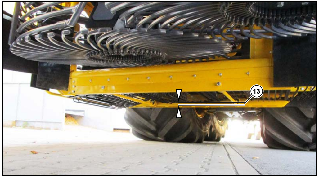
Elevatorband richtig gespannt
