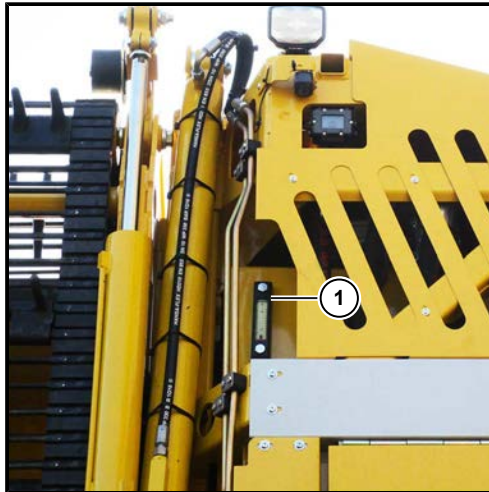
(1) Schauglas Ölstand + Öltemperatur
