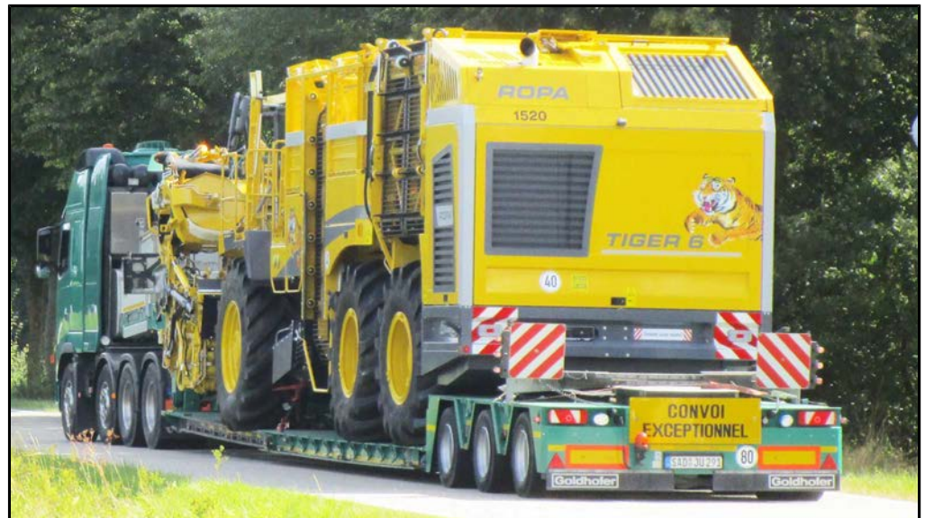
Ordentlicher Tieflader für Straßenstransport mit Minimaltransporthöhe
