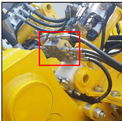
Hauptverteiler Exzenterantrieb Rüttelschar
