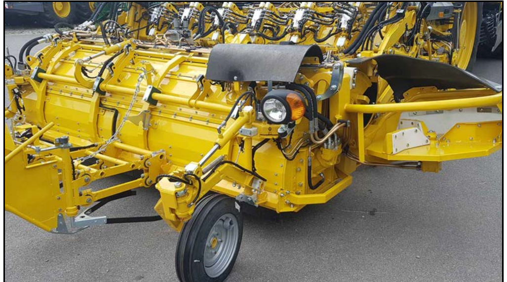
RASW-Schlegler, Schleglerklappe oben
